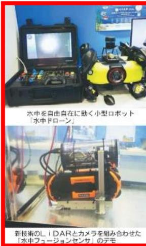
水中を自由自在に動く小型ロボット「水中ドローン」
